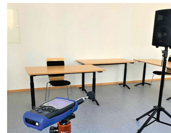
Messung der Nachhallzeit mittels Schallpegelmesser und Lautsprecher
